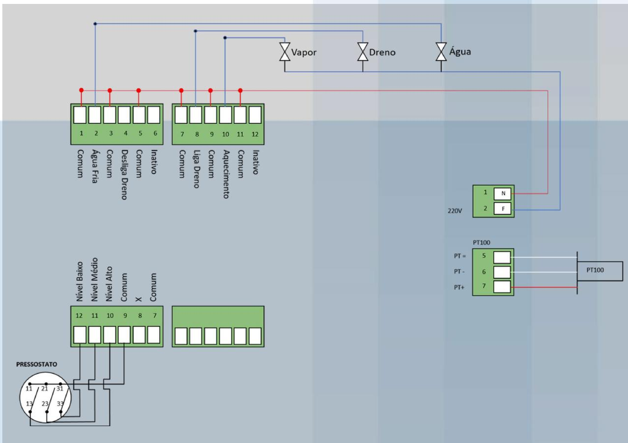
**Atenção:** Em caso de ligação dos periféricos em 24VCA, usar um transformador de entrada 220v e saída 24v, acima de 800mA.
